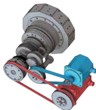
铣刀马达使用主轴马达驱动，换刀马达使用伺服马达驱动。
