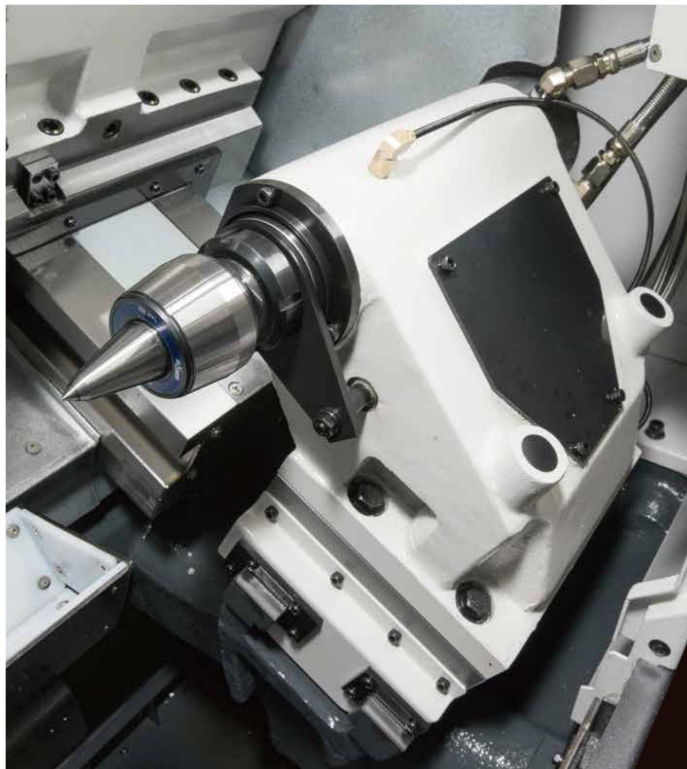
销牵引的心押台，可藉由Z轴伺服马达快速定位，缩短工时。
