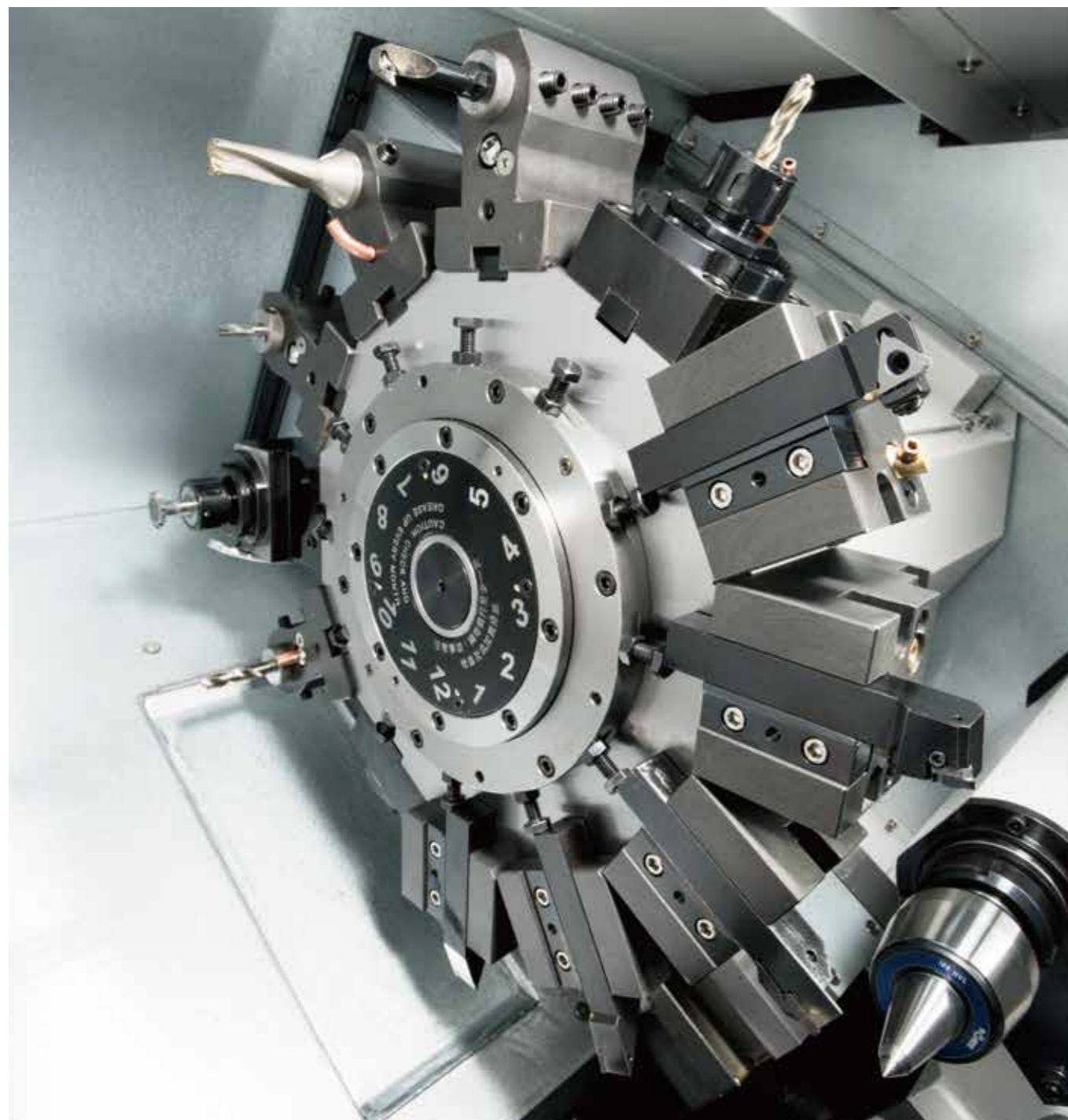
铣刀马达使用主轴马达驱动，换刀马达使用伺服马达驱动。
